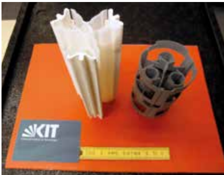
Abb. 5: Einzelsegmente gedruckter kontinuierlicher Kabelisolatoren aus PLA (links) und PA (rechts).
