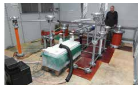
Abb. 3: Drehstromtest mit der Anlage Combutt mit einer Spannung von 86,6 kV (effektiv, Phase gegen Phase).
