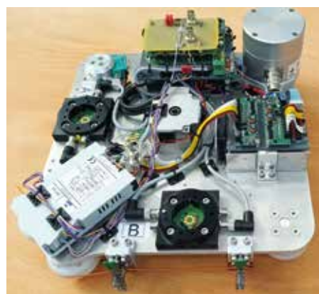
Abb. 1: Elektronikseite der Wickelhand. Links unten: PID-Zugkraftregler. Weiter im Uhrzeigersinn: Andockflansch für Roboter, Drehgeber zur Längenmessung, Elektronik zur S7-Anbindung, Zugkraftsensor, Motorsteuerung. In der Mitte: Servomotor.
