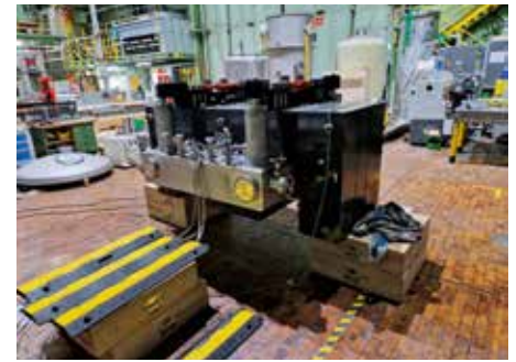
Abb. 7: Supraleitender Magnet des Magnetheizers im Stromtest am KIT mit Eisenjoch.
