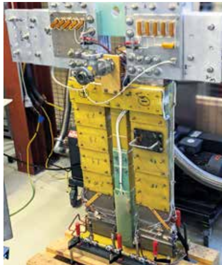
Abb. 6: Aufbau der druckdichten Durchführung inklusive zweier 20-kA-Stromzuführungen.
