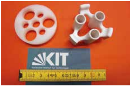
Abb. 4: PE-Scheibenisolator (links) und gedruckter PLA-Stützisolator (rechts).
